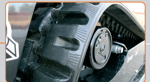
Sistema di rulli oscillanti Rocking rollers
