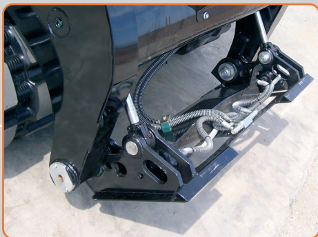
Sistema di attacco HYD universale Universal hydraulic quick attach
